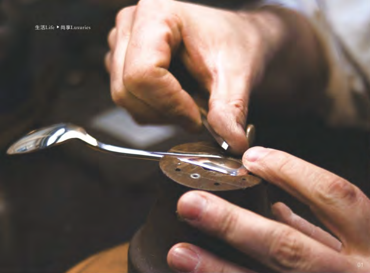
01. 工匠进行压印工艺 02. 浮雕一样的银具表面 03. 昆庭银器胎具
